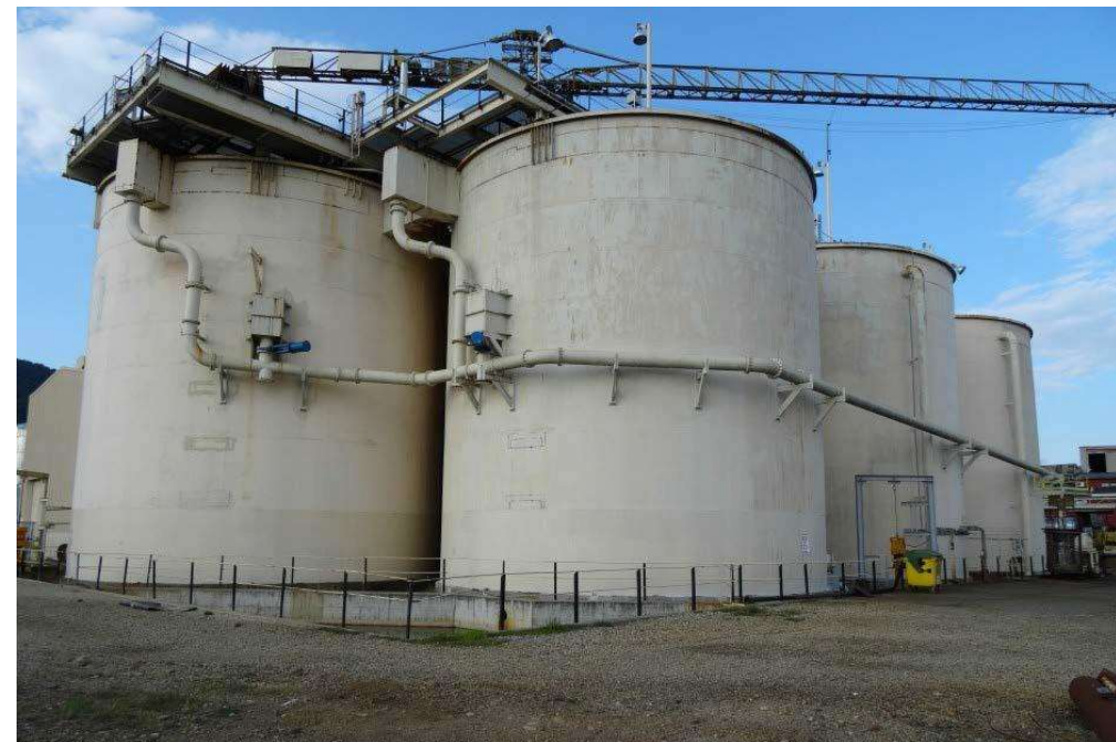
Технологические резервуары для цианирования
